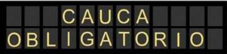
Figura 2. VMS de 2 Líneas, 12 caracteres Fuente: Elaboración propia
