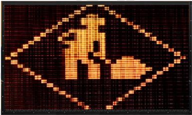
Figura 4. VMS de Matriz Completa (Full Matrix).
