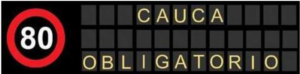
Figura 3. VMS de 3 Líneas y Pictograma Fuente: Elaboración propia
