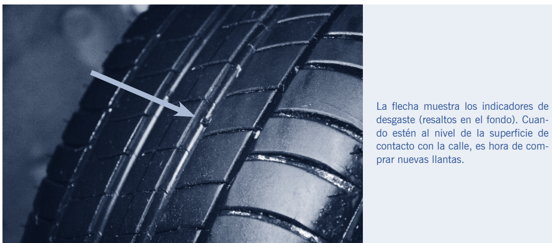
Gráfica 31. Indicadores de desgaste de la llanta
