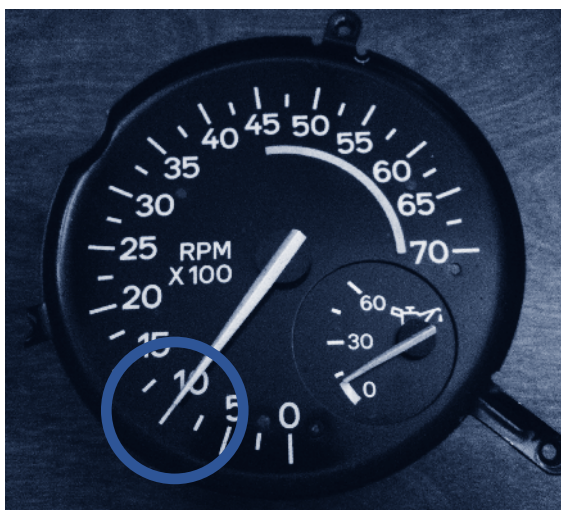
Gráfica 30. Velocidad mínima, ralentí o en vacío. Motor en funcionamiento sin aceleración del conductor
