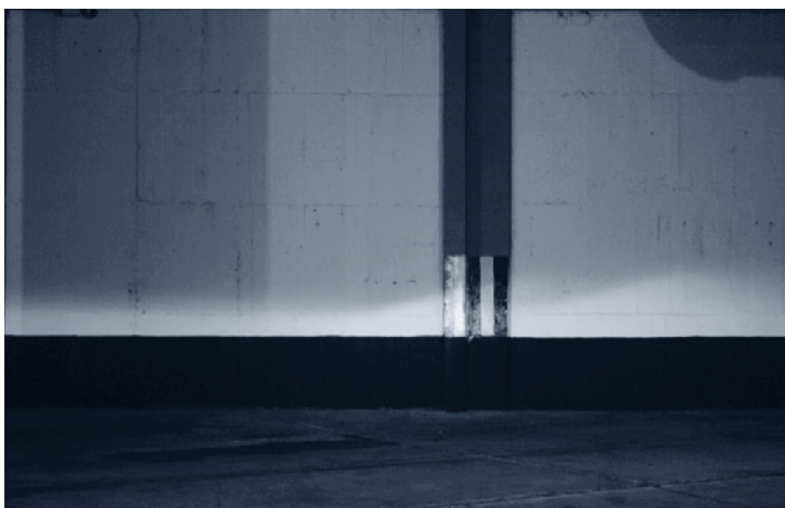
Gráfica 34. Proyección correcta del haz de luces medias en un muro a diez (10) metros
