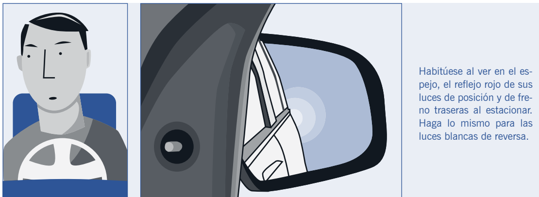
Ilustración 31. Verificación del funcionamiento de las luces traseras
