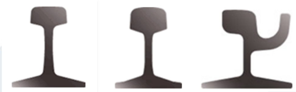
Figura 47.1. Perfiles tipo de riel: Izquierda perfil AREMA; centro perfil UIC; derecha perfil de viga
