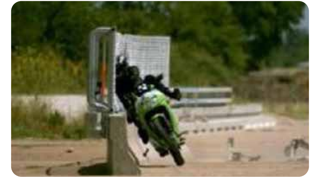
(2) Barrera rígida probada para protección de motociclistas
