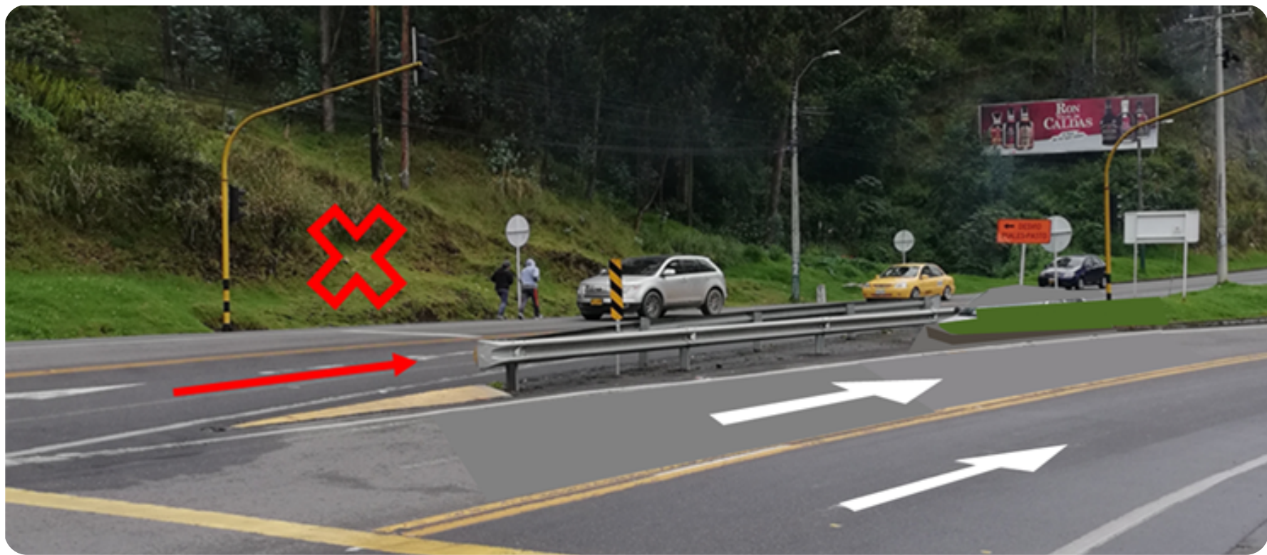
Figura 77. Tratamiento inadecuado de barreras en separador central.
