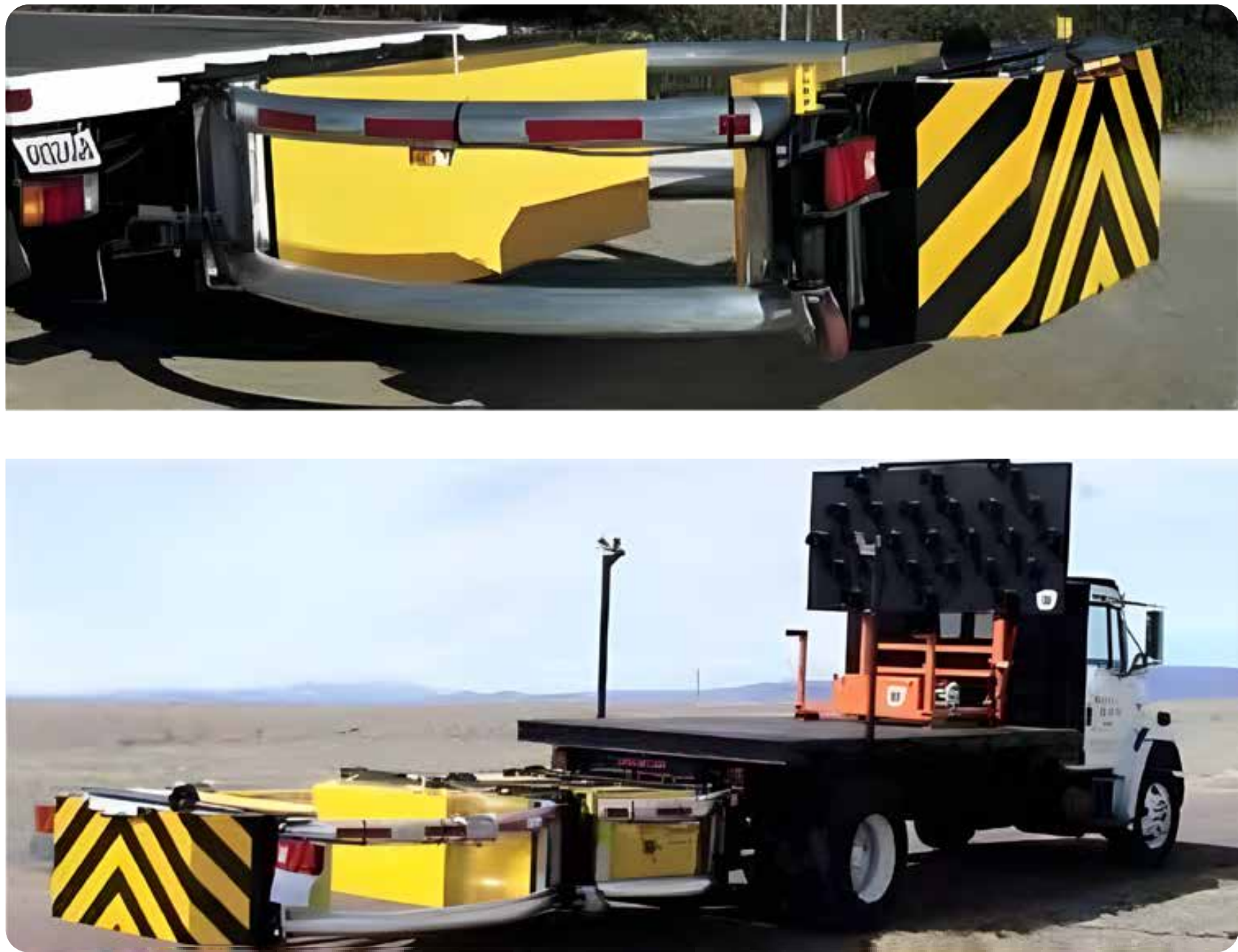
Figura 21. Amortiguador de impacto montado en un camión.
