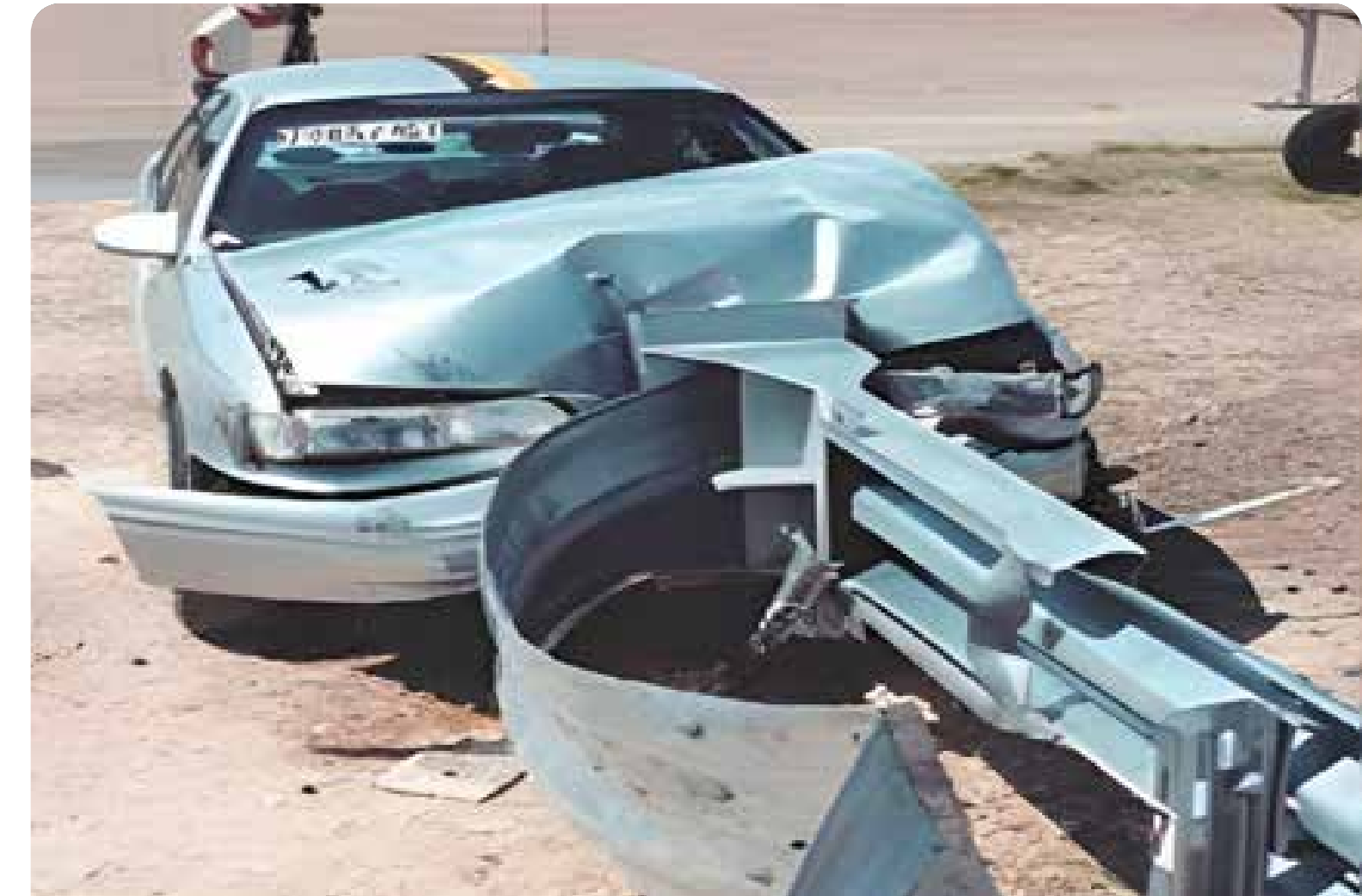
Comportamiento del terminal tipo TAI
