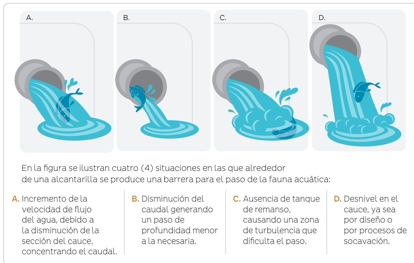
Figura 8. Ejemplo de deficiencias en el diseño de obras de drenaje trasversal, que constituyen barreras para el desplazamiento de la fauna acuática
