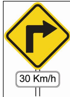
Figura 97 Señalización preventiva de curva peligrosa con velocidad sugerida.
