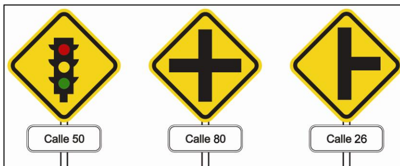
Figura 47. Ejemplo de ubicación de señales de nomenclatura vial (SI-26) bajo una señal preventiva de cruce.
