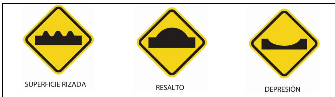
Figura 103 Señales que indican un perfil irregular
