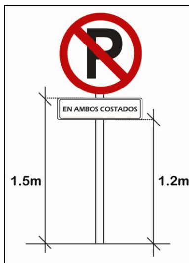
Figura 42 Altura de las señales verticales ubicadas a un costado de la carretera
