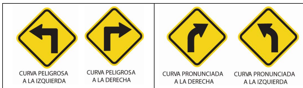
Figura 96. Dispositivos para señalizar curvas horizontales anticipadamente
