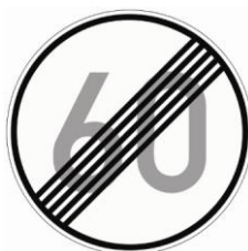
Figura 21 Señales de fin de prohibición o restricción de acuerdo con la Norma Española 8.1-IC
